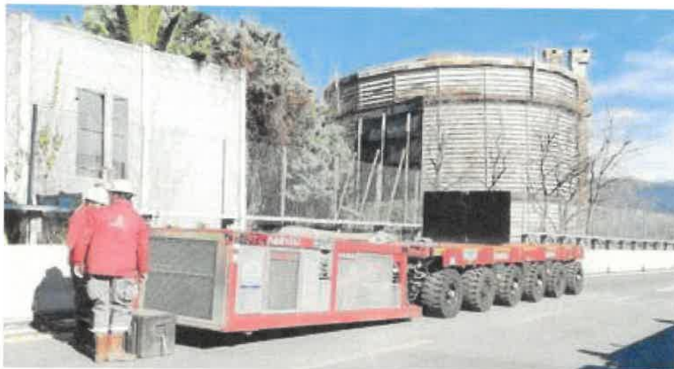
Il carrello robot testa il moncone di ponte del Morandi
